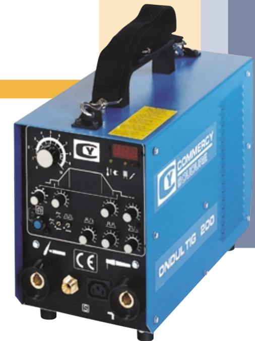
L'ONDULTIG 200 est un générateur portable, possédant un cycle de soudage programmable extrêmement complet. Il délivre un courant continu, permettant le soudage en procédé TIG et électrode enrobée de tous les aciers au carbone ou inoxydables. Il est doté d'origine d'un afficheur numérique, du mode de soudage pulsé à fréquence réglable et du mode de soudage point.
