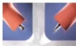
Le soudage de l'aluminium avec électrode en pointe permet d'augmenter la pénétration et de stabiliser l'arc
