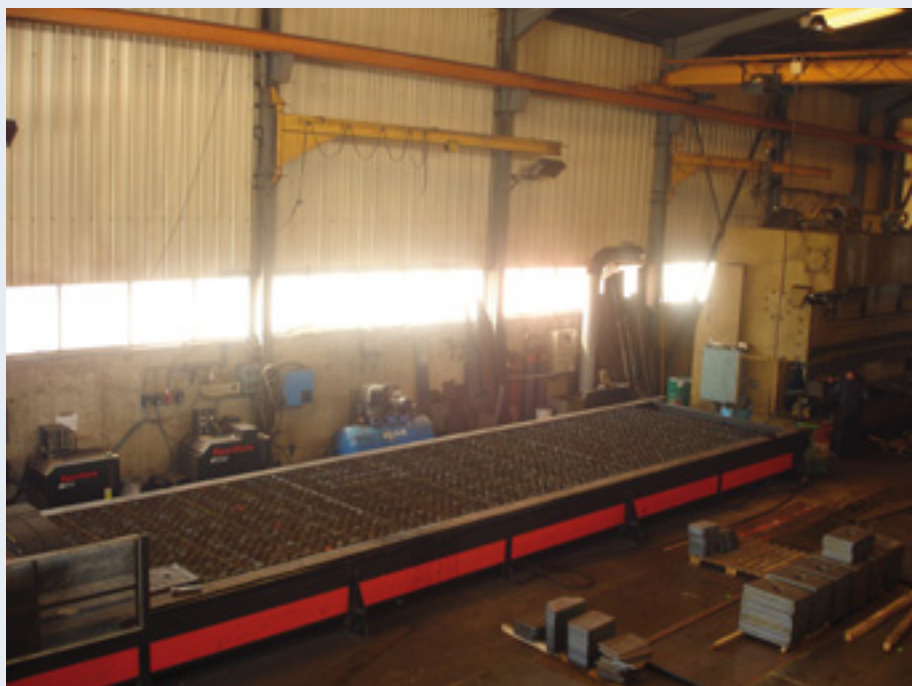
Fig. 41. Vue générale de la table de découpe plasma.
