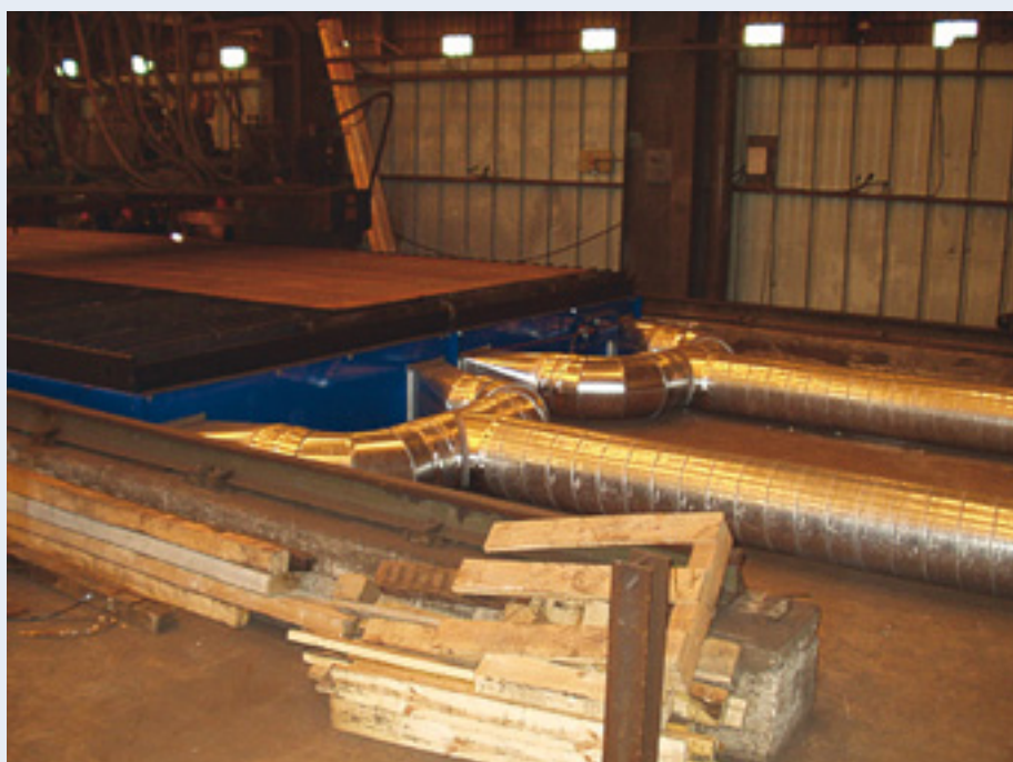
Fig. 40. Extraction des polluants sur la table 2.
