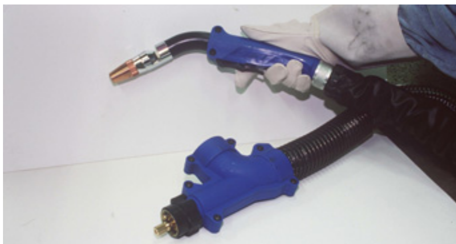
Fig. 5. Exemple de torche aspirante.
