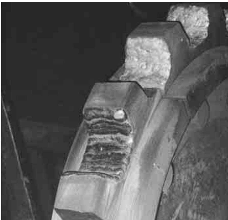
Roue dentées d'entraînement: Maintenance préventive avec OK 83.28.
