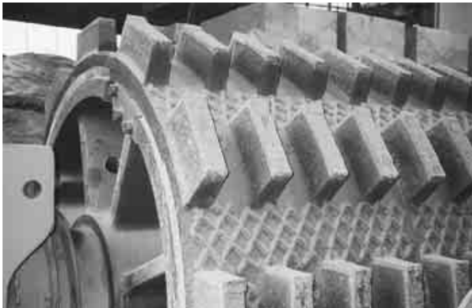
Dents de broyeur: OK 86.20 en passe de sous-couches, OK 84.78 rechargement dur Motif en quadrillage: OK Tubrodur 14.70.
