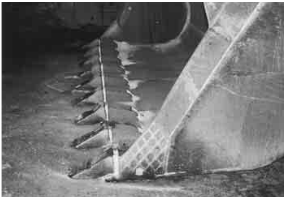
Rechargement dur avec OK 84.58
