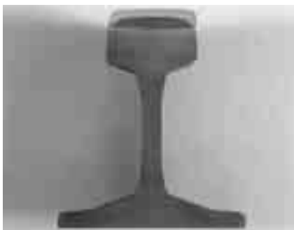
Rail en acier au carbone et au manganèse: OK Tubrodur 15.43
