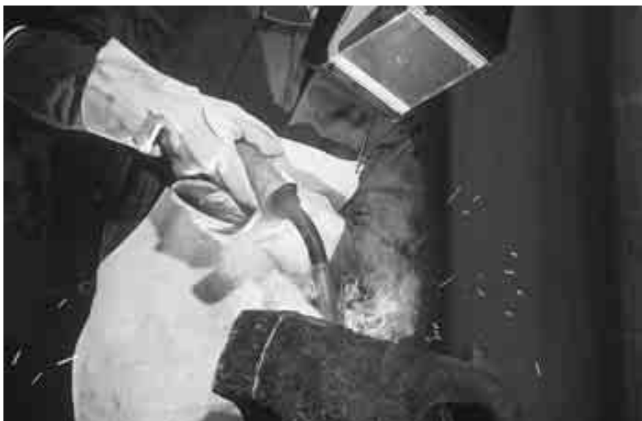
Marteaux broyeurs: OK Tubrodur 15.65.
