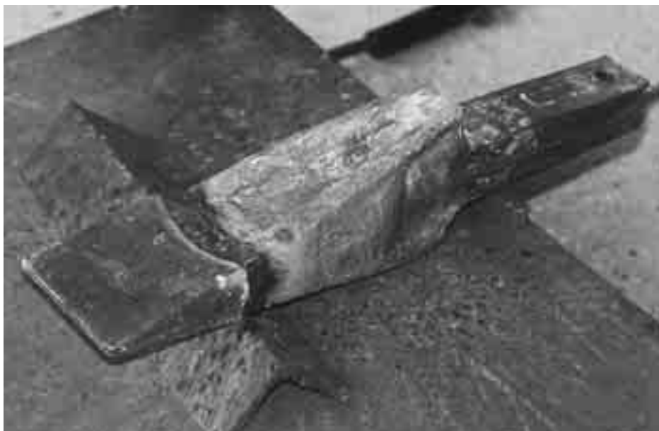
Assemblage de dents de godet neuves avec OK 67.45 ou OK Tubrodur 14.71.
