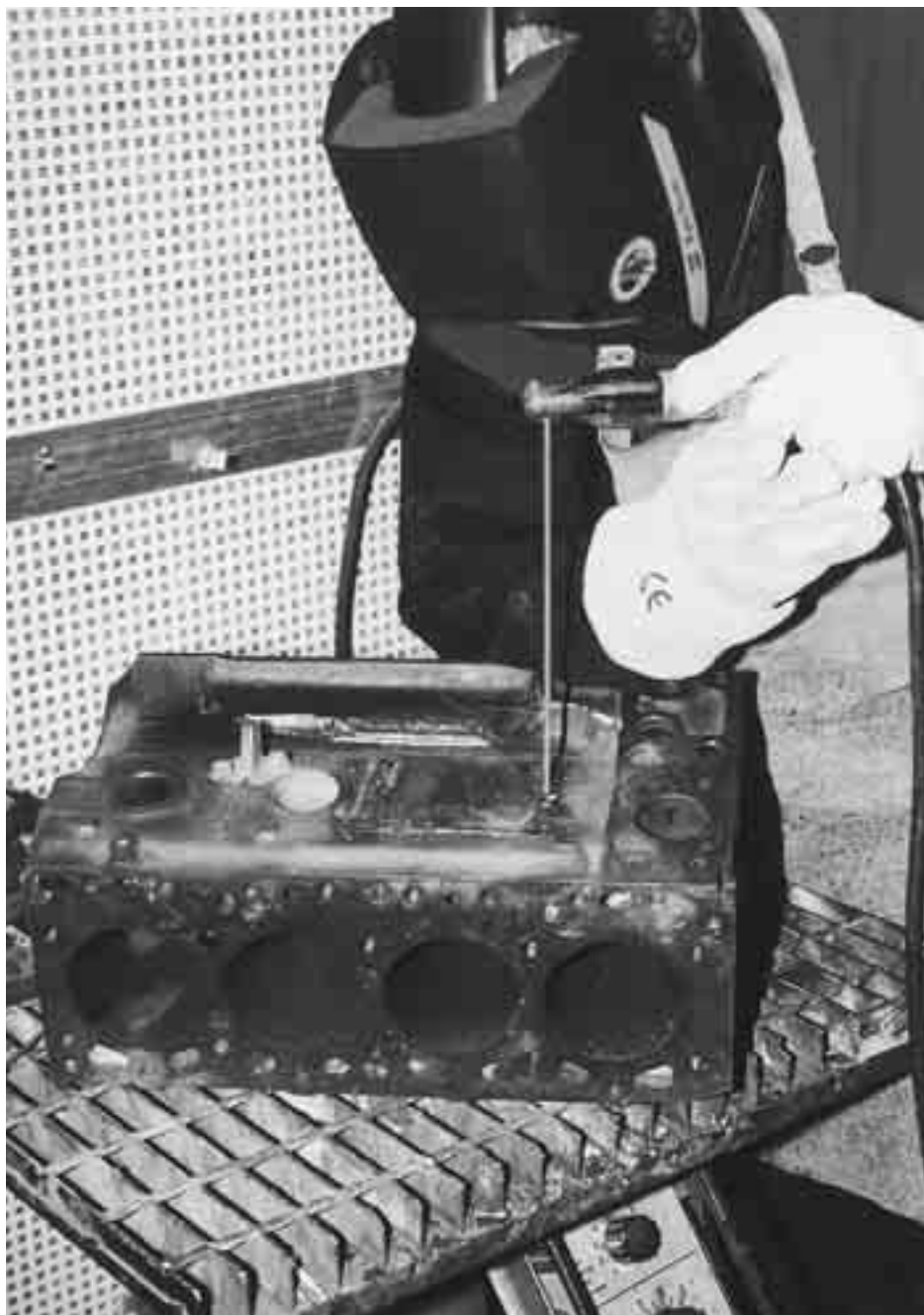
Bloc moteur en fonte réparé avec les électrodes OK 92.18 et OK 92.60.
