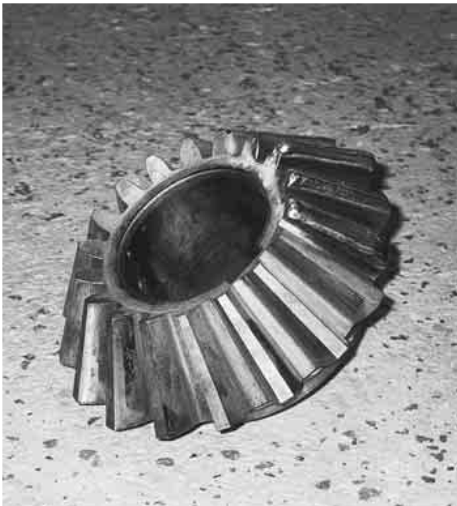
Pignon d'engrenage, réparé avec OK 68.82.
