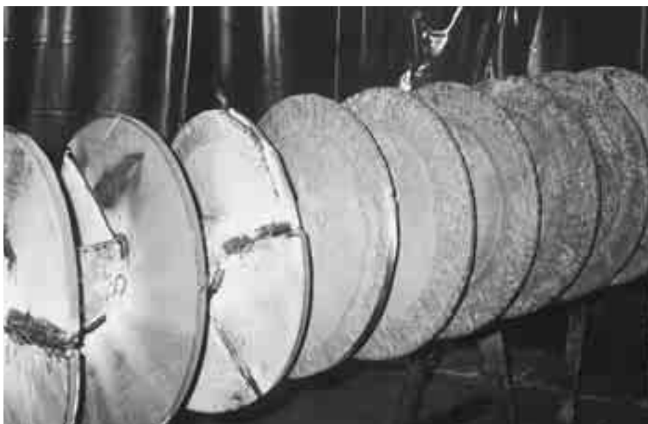
Vis d'alimentation: rechargement dur avec OK Tubrodur 14.70.
