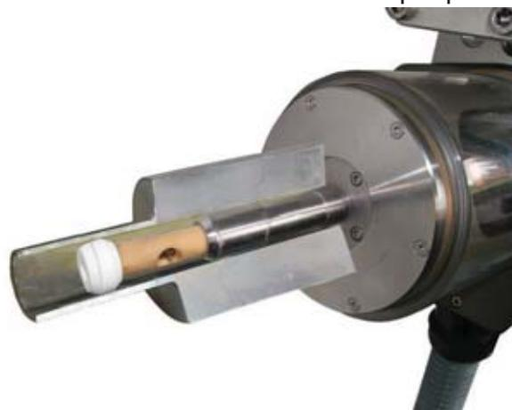
Exemple de soudage tube arrière-plaque
