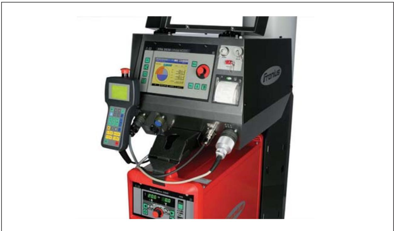
Commande de système orbital FPA 2030 avec générateur de soudage
