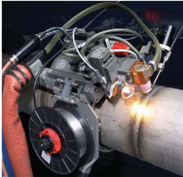
(3 1/2") de diamètre extérieur minimum, nécessitant des passes multiples avec apport de fil chaud ou froid. Elles tournent autour des tubes sur des rails appropriés à l'application. La conception, très modulaire, de ces têtes de soudage permet d'embarquer les équipements tels que le moteur d'entraînement fortes charges, la torche asservie, un dévidoir équipé d'une bobine de fil de 5 kg et, en option, des caméras vidéo permettant de visualiser et contrôler les soudures.
