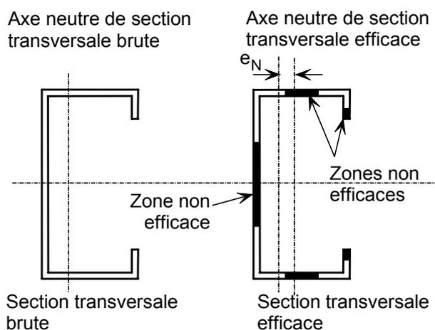
**Figure 4.2** Section transversale de Classe 4 comprimée
