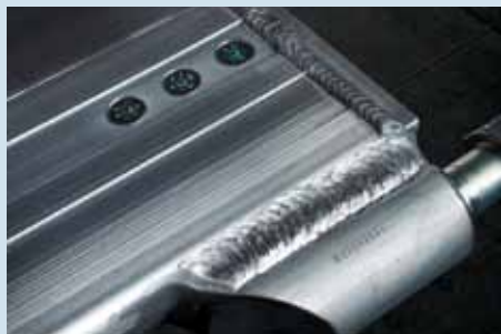
MISON® He20: soudures MIG sur un élément de carrosserie
