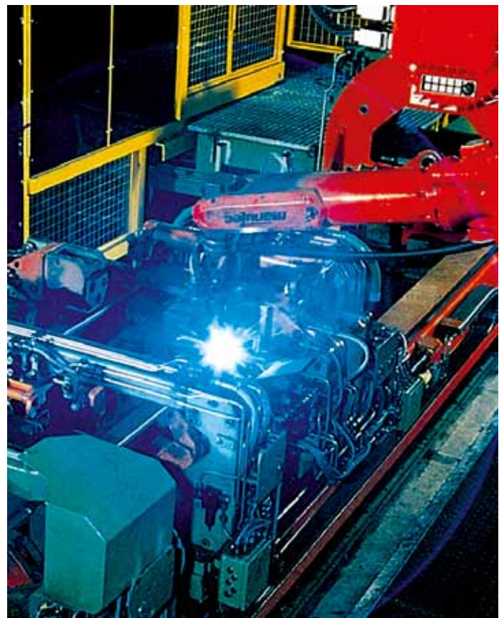
Utilisation du CORGON® 18 pour le soudage robotisé de mâts de levage
