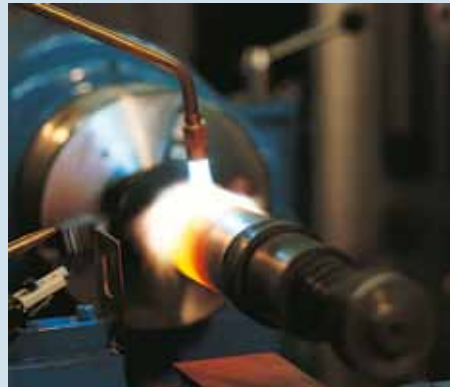
Chauffe à la flamme
