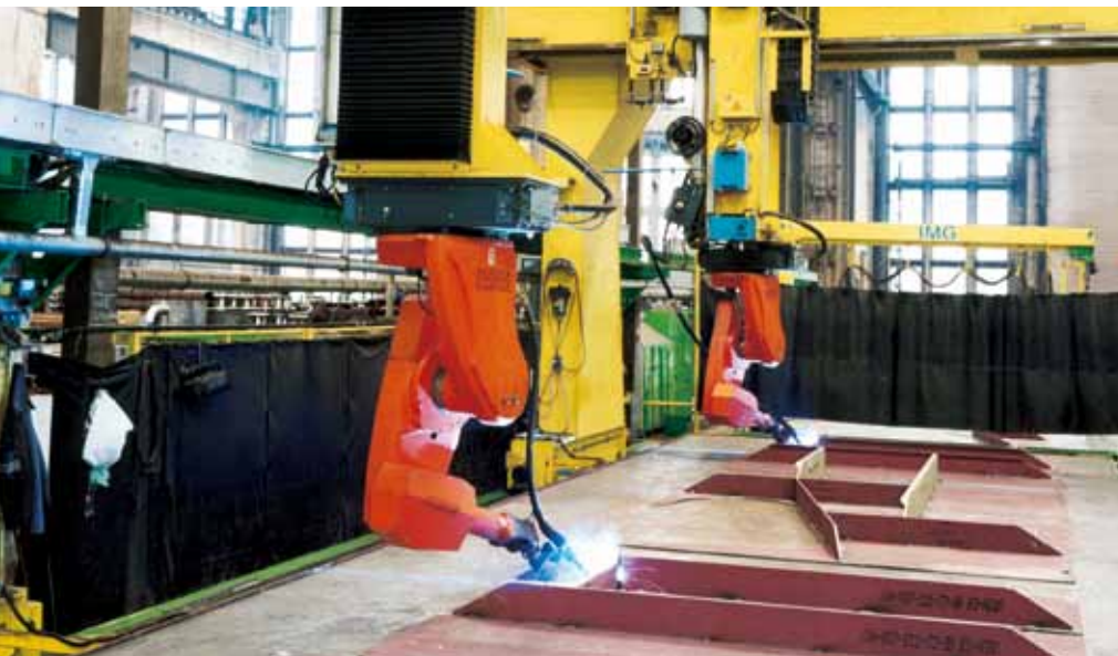
Utilisation du CORGON® 15/5 pour le soudage MAG robotisé
