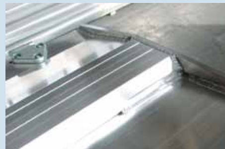
MISON® He20: soudure MIG sur une pièce en aluminium
