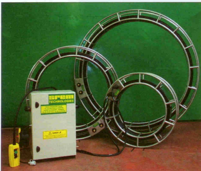
Figure 12 : Système pour la désaimantation de pipes.
