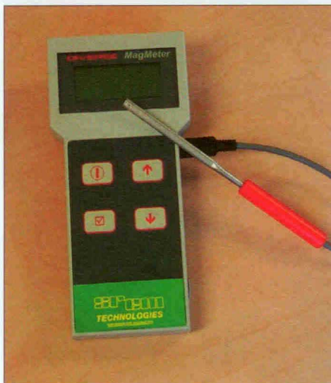
Figure 7 : Mesureur de champ magnétique avec sonde plate pour un accès facile à l'intérieur du joint de soudure.
